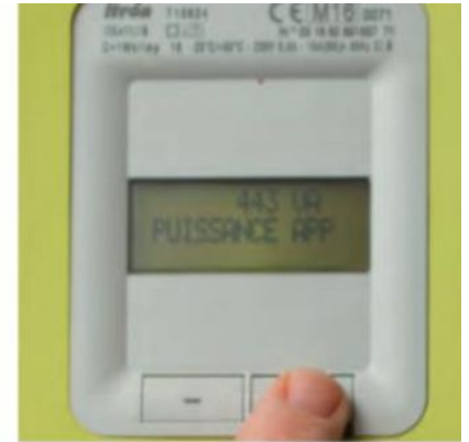
▲ Le compteur d'électricité domestique mesure la puissance apparente S (en VA), et non la puissance moyenne utilisée (en W).
